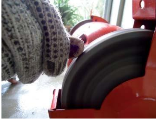
Escarificação de sementes de jatobá ( Hymenaea courbaril L.) utilizando o esmeril elétrico.
